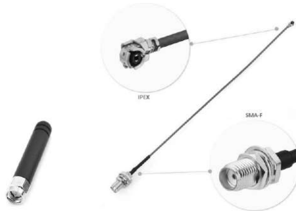
Рисунок 4.5 — Антенна и адаптер подключения
