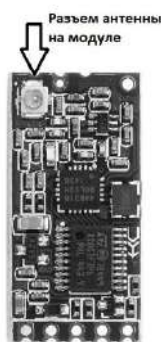
Рисунок 4.9 – Разъем для подключения адаптера
