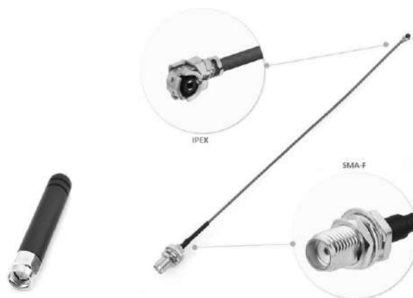
Рисунок 4.8 – Антенна и адаптер подключения
